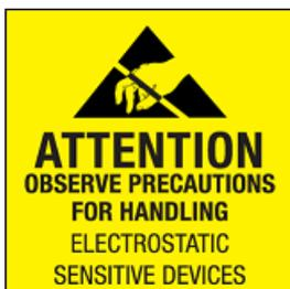
每次操作 EGo1 板卡之前，人体应短暂接地(例如用手摸一下接地的金属导体)以泄露身上的静电荷。或者使用专用防静电工具，例如防静电手环，如下图所示。
